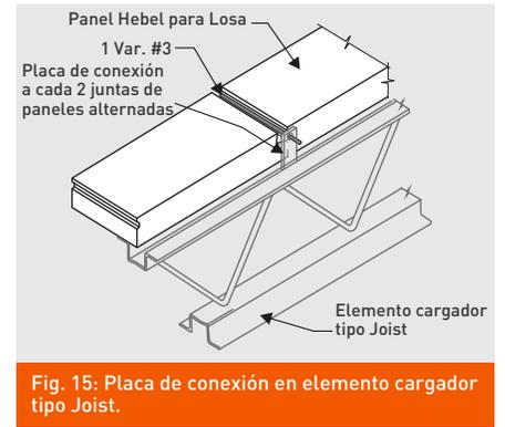
Fig. 15: Placa de conexión en elemento cargador tipo Joist.
